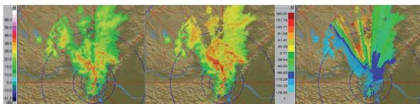
**Abb. 14** PPI auf 1° von WXR RAU vom 8. Juni 2012 um 18:37 UTC. Links unkorrigiertes  $Z_H$ , mittig wurde eine Korrektur für die Ausbreitungsdämpfung an  $Z_H$  angebracht, unter Verwendung der (rechts abgebildeten) differentiellen Phasenverschiebung.
