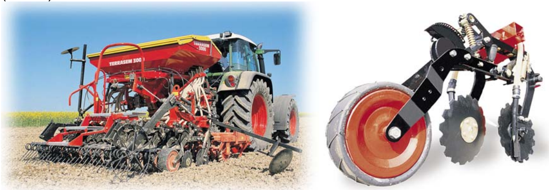
Abb. 6: Mulchsaatmaschine Terrasem von Pöttinger; rechts Säelement (Einscheibenschar kombiniert mit Schleppschar).
