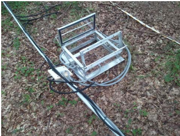
Automatische Messkammer zur Bestimmung der Bodenemissionen von Kohlendioxid, Lachgas und Methan. © Foto: Sonja Leitner
